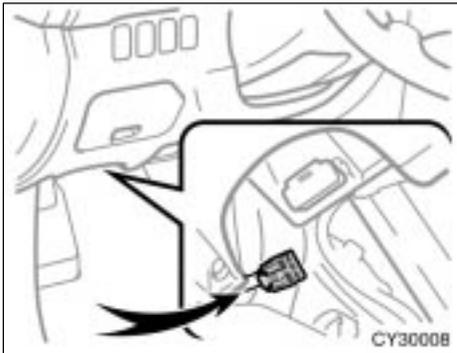
**SERVICE CONNECTOR FOR TOWING BRAKE CONTROLLER**
