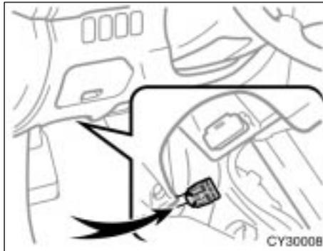
**SERVICE CONNECTOR FOR TOWING BRAKE CONTROLLER**
