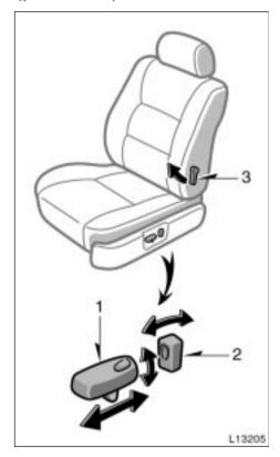
1. SEAT POSITION AND SEAT CUSHION HEIGHT ADJUSTING SWITCH
