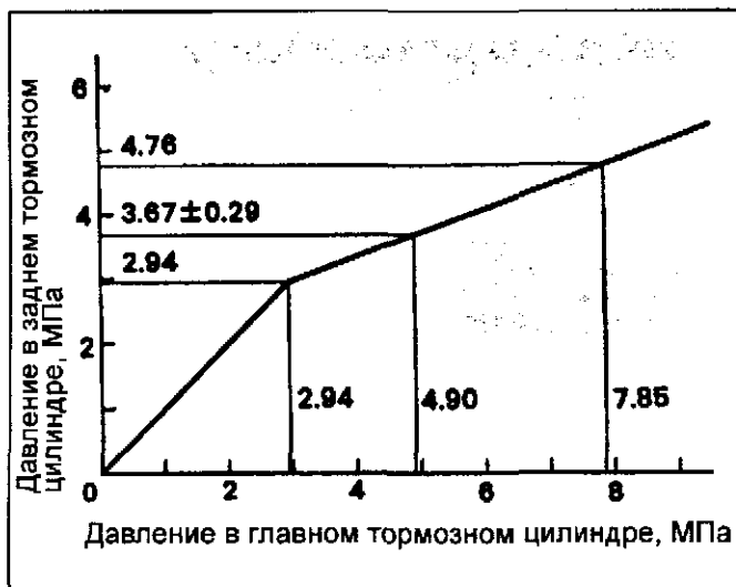
График работы регулятора давления (5A-FE, 7A-FE).
