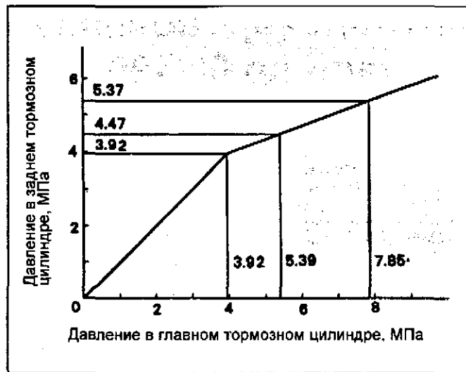
График работы регулятора давления (4A-GE до 08.1998 г.).
