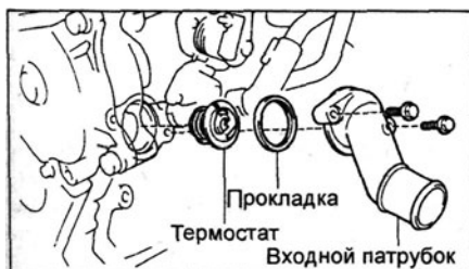
Снятие и установка термостата (Estima Emina/Lucida). 1 - прокладка, 2 - термостат, 3 - входной патрубок охлаждающей жидкости (кронштейн троса управления ТНВД), 4 - правая крышка моторного отсека, 5 - левая крышка моторного отсека, 6 - напольное покрытие, 7 - правая крышка моторного отсека.
