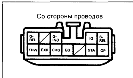
Разъем таймера свечей накаливания со стороны жгута проводов (модели выпуска с мая 1995 года).
