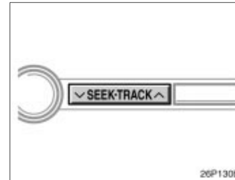
(d) Selecting a desired track "SEEK-TRACK" button:
