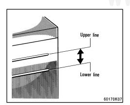
CHECKING BY THE FLUID LEVEL LINES (MAINTENANCE TYPE BATTERY ONLY)
